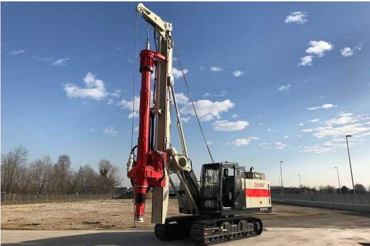
CH 450 Macchina di perforazione ditta Comacchio
